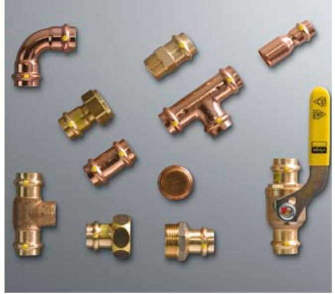
**Viega Profipress G** 是一种卡压接头系统，已经无数次地证明了其实力。它采用铜管、高品质 HNBR 密封件和智能安全措施，足以令人信服。该系统是天然气管道防火安装或机械安装的理想选择，经过德国标准认证，几乎适用于全部含有易燃介质的管道的安装。用于天然气管道的接头，符合德国组织 DVFG (Deutscher Verband für Flüssiggas) 标准；用于民用燃油和柴油燃料管道的接头，符合德国 DIBT (Deutsches Institut für Bautechnik)。
