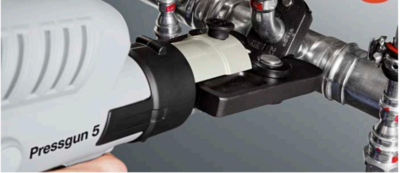
1994 年以来，Viega 在卡压技术领域就始终处于领先地位。Viega 卡压接头的范围包括了从 12 mm 到 108 mm 尺寸不等的各种安装连接种类。它们为饮用水、天然气、采暖和特殊应用领域提供了各种实用的解决方案。并且完全无需焊接、钎焊或切削螺纹。
