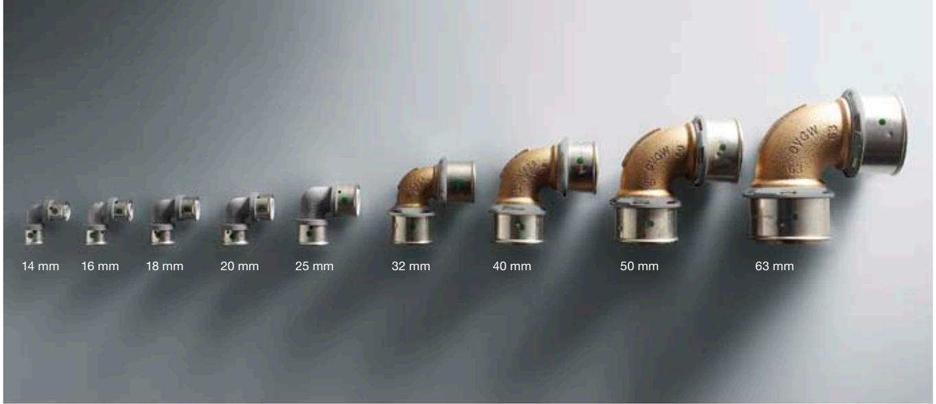
Viega Pexfit Pro 系统根据您的需要来定制。Pexfit Pro 管道如您所愿般灵活，亦如您所期望般耐用可靠。PPSU 制成的新型卡压接头与 Viega 红色黄铜接头相结合，几乎适合房屋内的一切安装。Pexfit Pro Fosta 管道由三层结构组成：PE-Xc 内管、铝层和外部白色涂层。
